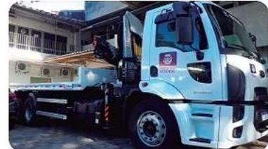
Caminhão prancha para o transporte de máquinas pesadas no município de Resende (Indicação N°309/2017)
